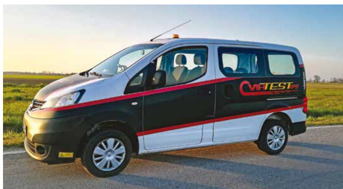
1. Il Viatest RPS (Road Profile Scanner), il veicolo per il monitoraggio delle strade che fornisce, in modo automatizzato, informazioni sulla geometria e sulle caratteristiche superficiali delle pavimentazioni stradali
